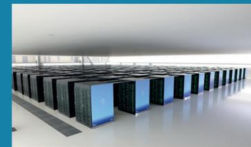
Der Supercomputer Fugaku wird in Japan in Betrieb genommen. Er rechnet mit 442 PetaFLOPS. Solche Computer sind besonders geeignet, um mit Big Data, also riesigen Datenmengen, umzugehen. Um diese aufzubewahren und zu analysieren braucht es sehr große Speicherkapazitäten. Für KI-Systeme sind diese Datensammlungen sehr nützlich, da sie Daten nutzen, um ein bestimmtes Verhalten (wie z.B. Gesichter erkennen) zu erlernen.
